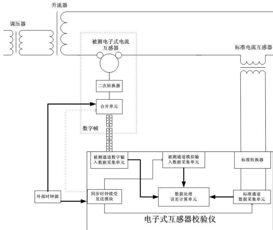
图4 电子式电流互感器检定回路（同步脉冲法）
