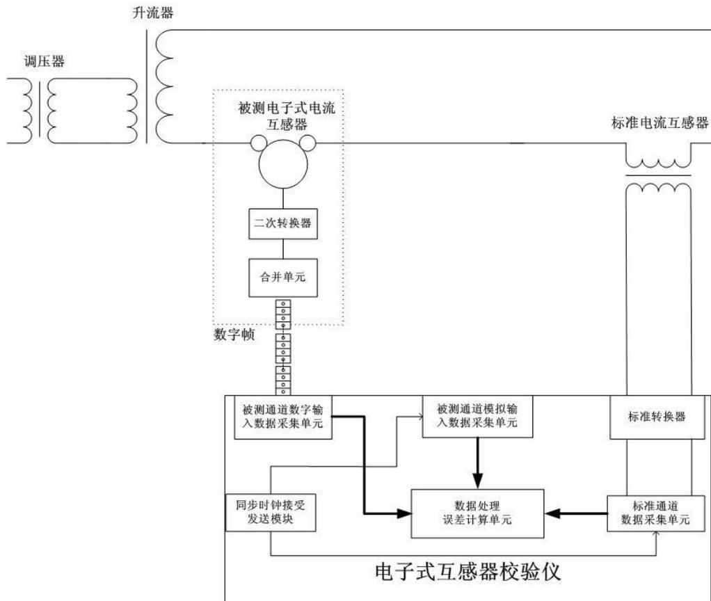
图 5 电子式电流互感器检定回路（固定延时）
