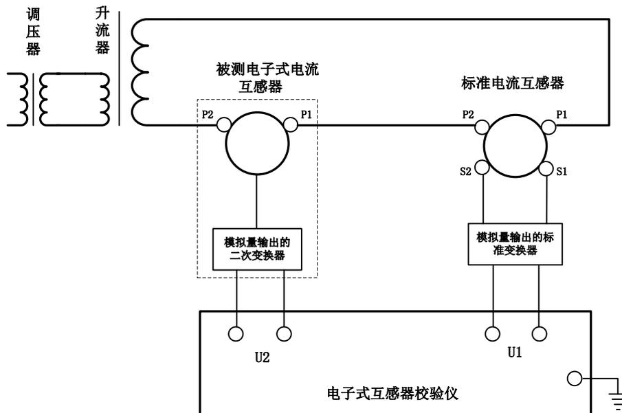
图3 模拟量输出电流互感器检定线路
