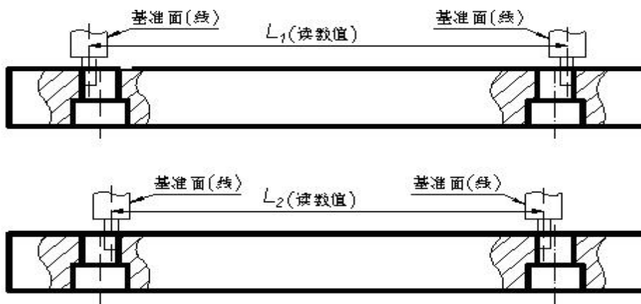
图B.2 起始值为“零”值时的示值检测读数示意图（圆柱测头）
