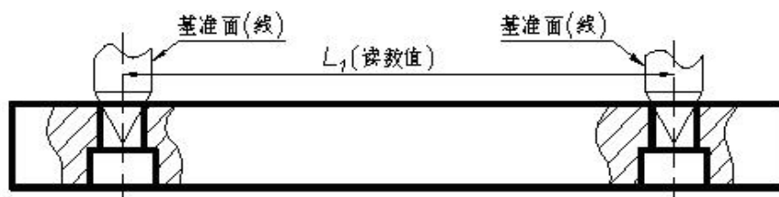
图 B. 3 起始值为测量范围标定初始值时的示值检测读数示意图 (圆锥测头)
