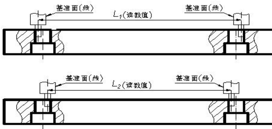
图B.1 起始值为测量范围标定初始值时的示值检测读数示意图（圆柱测头）
