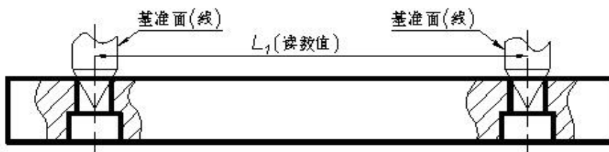
图 B. 4 起始值为“零”值时的示值检测读数示意图 (圆锥测头)
