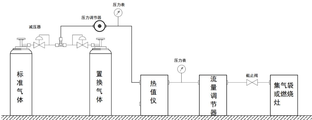
图 1 典型管路连接示意图
